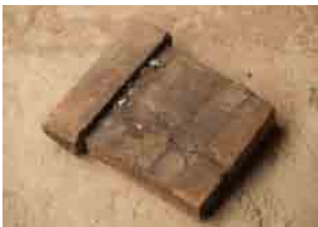
DIENTE DE MADERA DE ENCINA DE UNA RUEDA DEL SISTEMA DE ENGRANAJES
